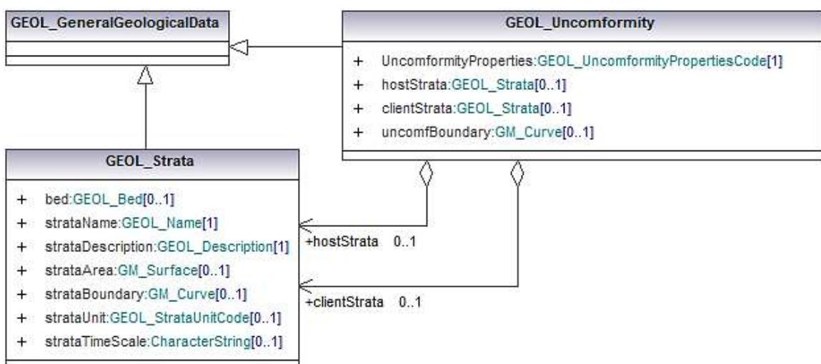
圖 9、不整合 (GEOL\_Unconformity) UML 應用綱要
