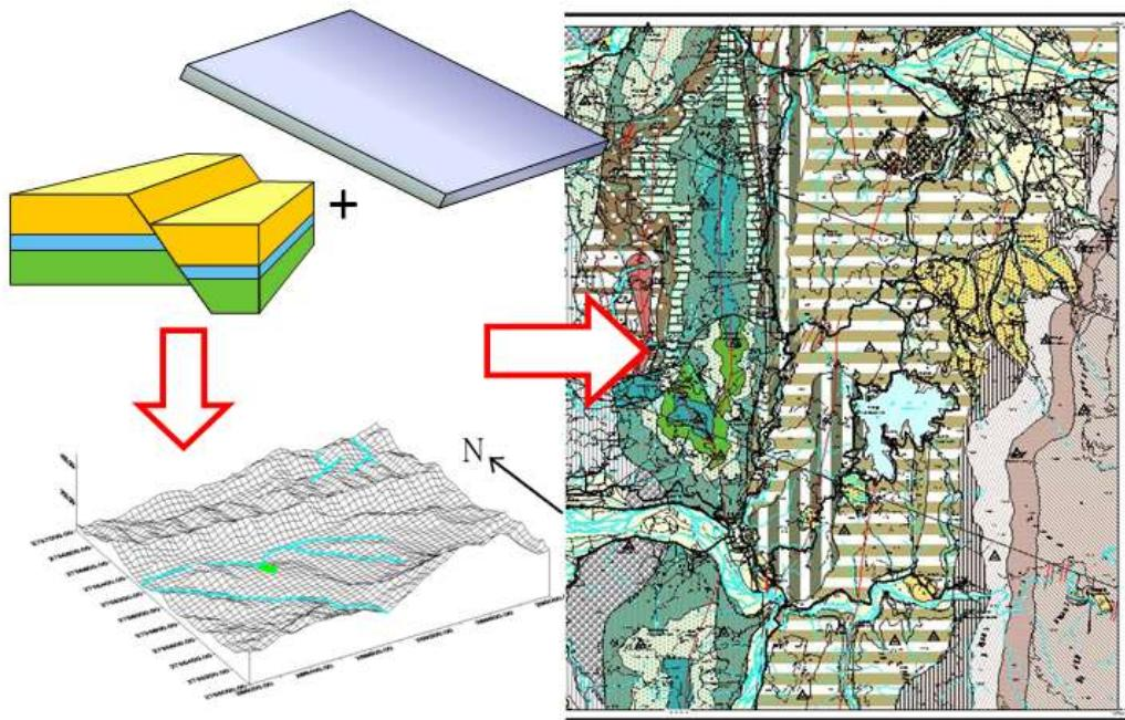
圖 4、地質圖組成之示意圖
