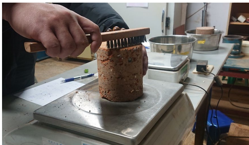
圖 3-10 頂部磨損操作示意圖【文獻 3.13】
