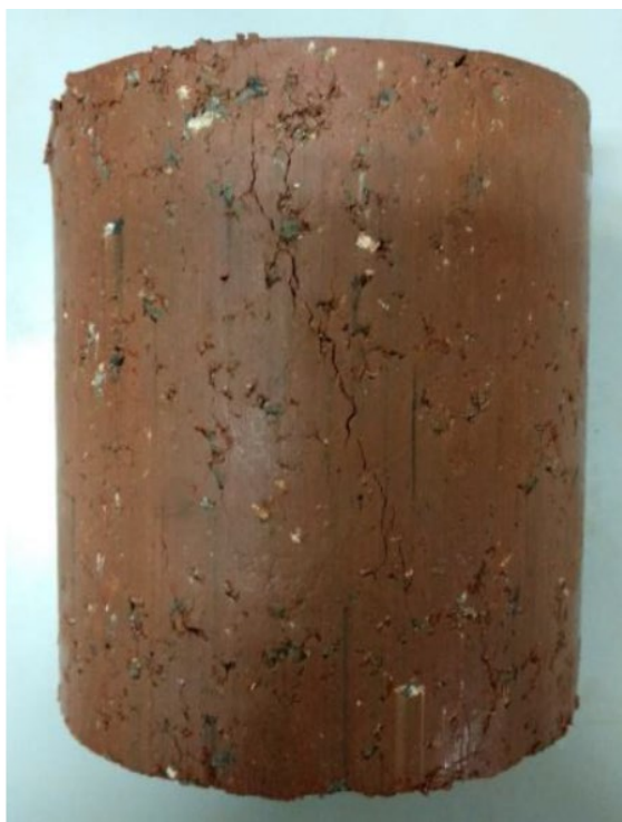
圖 4-18 無圍壓縮試驗完成後的配比 0.8 標準夯實試樣【文獻 4.16】
