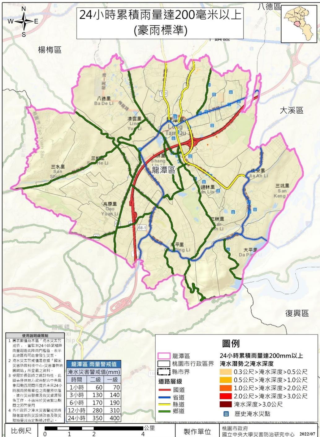
圖 12 龍潭區 24 小時累積雨量達 200 毫米淹水潛勢圖<sup>42</sup>
