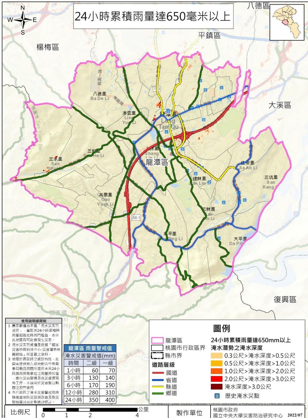
圖 24 龍潭區 24 小時累積雨量達 650 毫米淹水潛勢圖<sup>57</sup>
