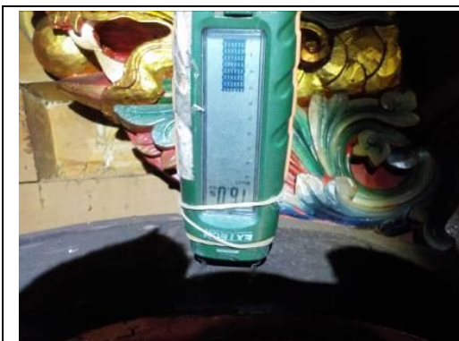
照片 1-2-6 電阻式木材含水率計
