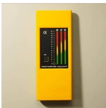
照片 5-1-21 牆體磚石材測濕計
