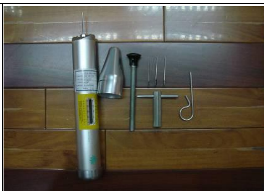
照片 1-2-7 木材表面腐朽偵測儀
