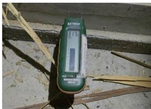
照片 5-1-2 電阻式含水率計量測範例
