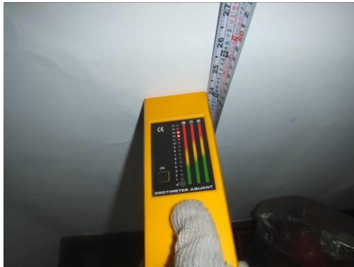
牆體編號 B-23 處量測結果為 13，為潮濕狀態
