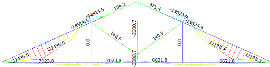
圖 5-2-72 管理室 - D+L+E 載重組合彎矩圖 (kgf-cm)
